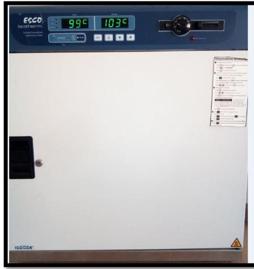
**Figure 29:** Étuve utilisée pour la dessiccation des échantillons (photo personnelle).
