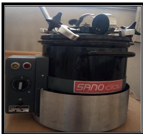
**Figure 27:** Autoclave de marque Sanoclav (photo personnelle).
