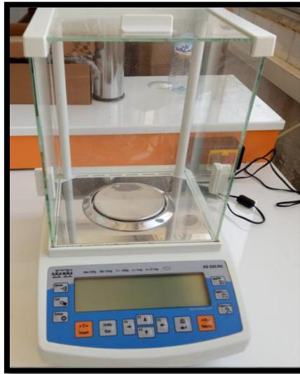
**Figure 28:** Balance analytique de précision (photo personnelle).
