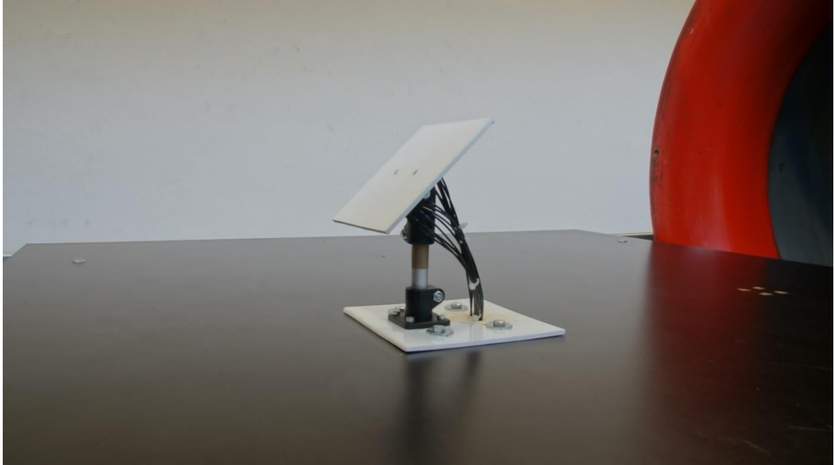
Figure - 3.1 : Avant du modèle de l'héliostat installé dans la soufflerie (Hochschule Esslingen).
