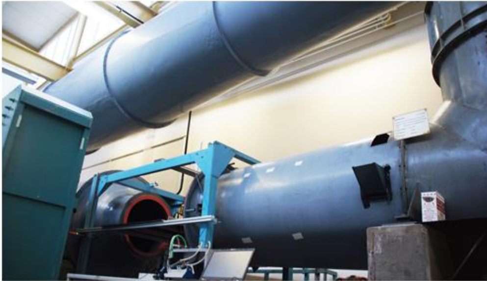
Figure - 3.11 : Soufflerie -type Göttingen- utilisé pour l'étude expérimentale [laboratoire de la mécanique énergétique -Université des sciences appliquée – Hochschule Esslingen].
