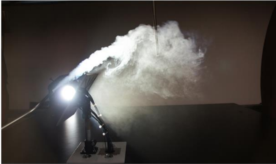
Figure - 3.14 : Visualisation des tourbillons autour du modèle de l'héliostat avec des tubes pression.
