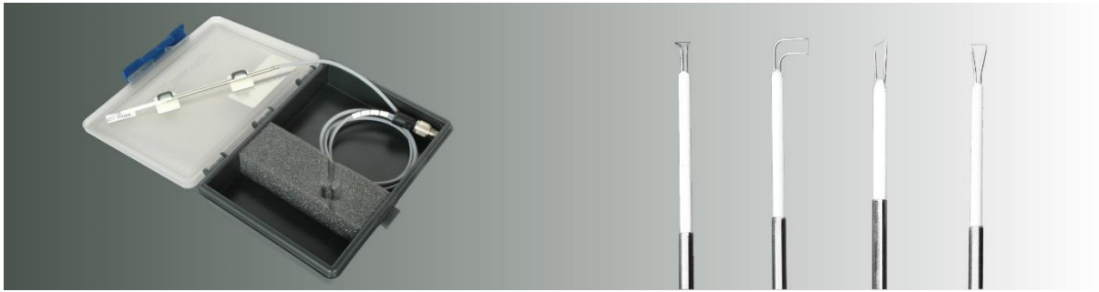
Figure - 3.7 : Sondes du fil chaud avec les ponts eCTA, aCTA et eCCT [69].
