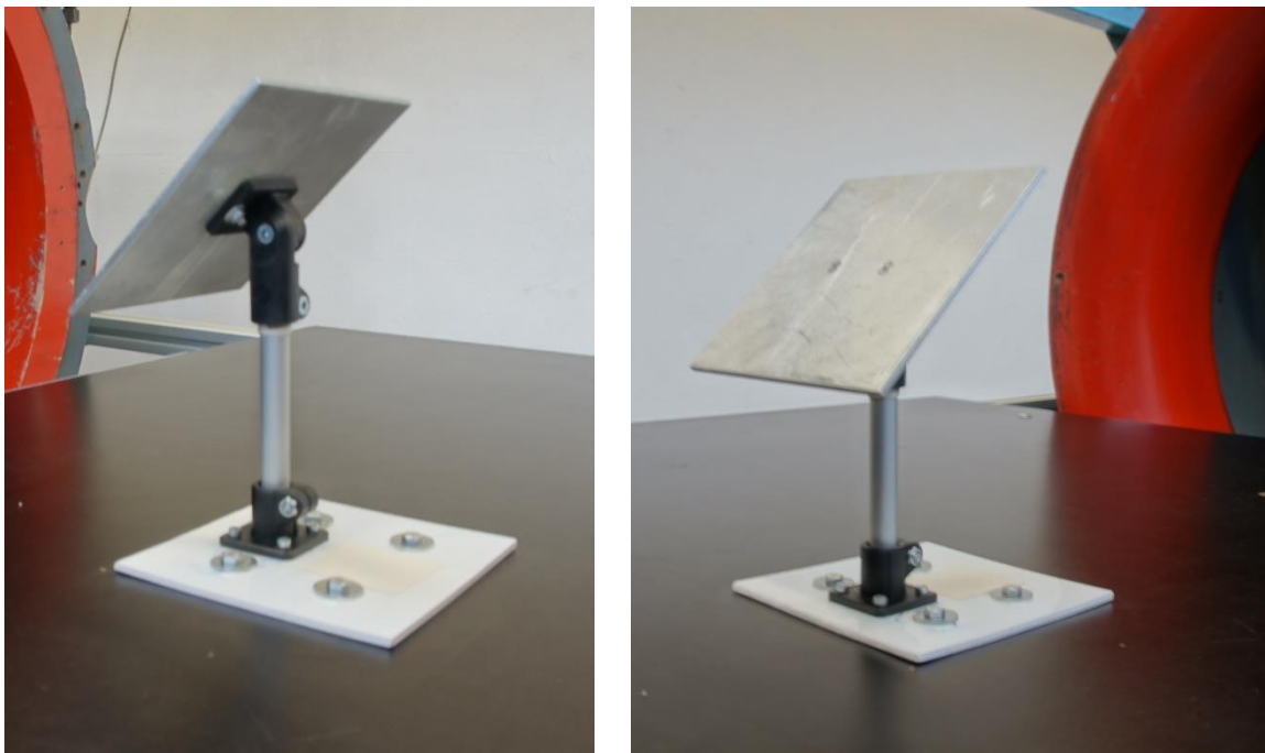
Figure - 3.5 : Modèle d'héliostat installé dans la soufflerie pour les mesures de la fréquence des tourbillons.
