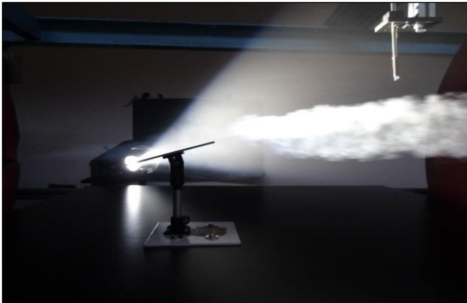
Figure - 3.15 : Visualisation des tourbillons autour du modèle de l'héliostat simple.
