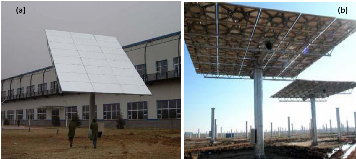
Figure – 1.5 : a) Héliostat à une position générique [28], b) Héliostat à une position d'arrimage [29].
