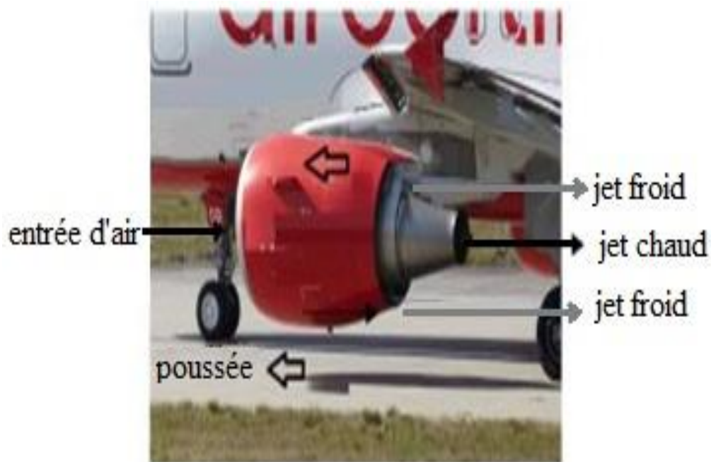
Figure I.28 : Impact des différents jets sur la poussée d'un avion
