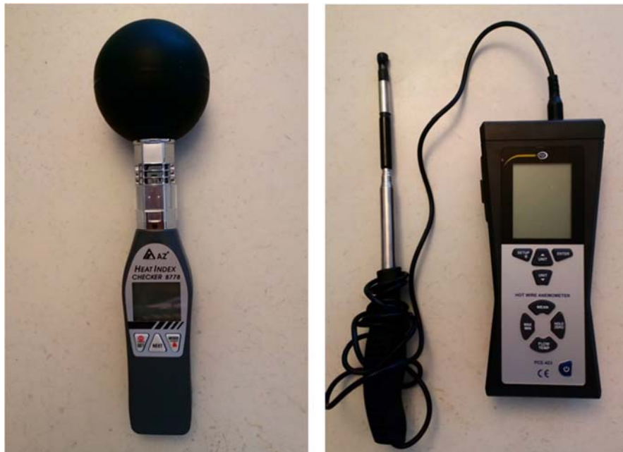
Figure 53: Matériels de mesure utilisés pour la campagne d'été. À gauche, Heat Index Cheker 8778, à droite Hot Wire Anemometer (PCE-423). Source : Auteurs
