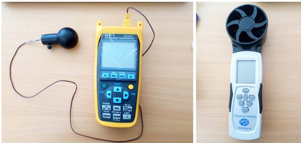
Figure 52 : Matériels de mesure utilisés pour la campagne d'hiver. À gauche, data logger thermometer (YC-747U) à droite thermo-hygro-anemometer (PCE-THA 10). Source : Auteure.
