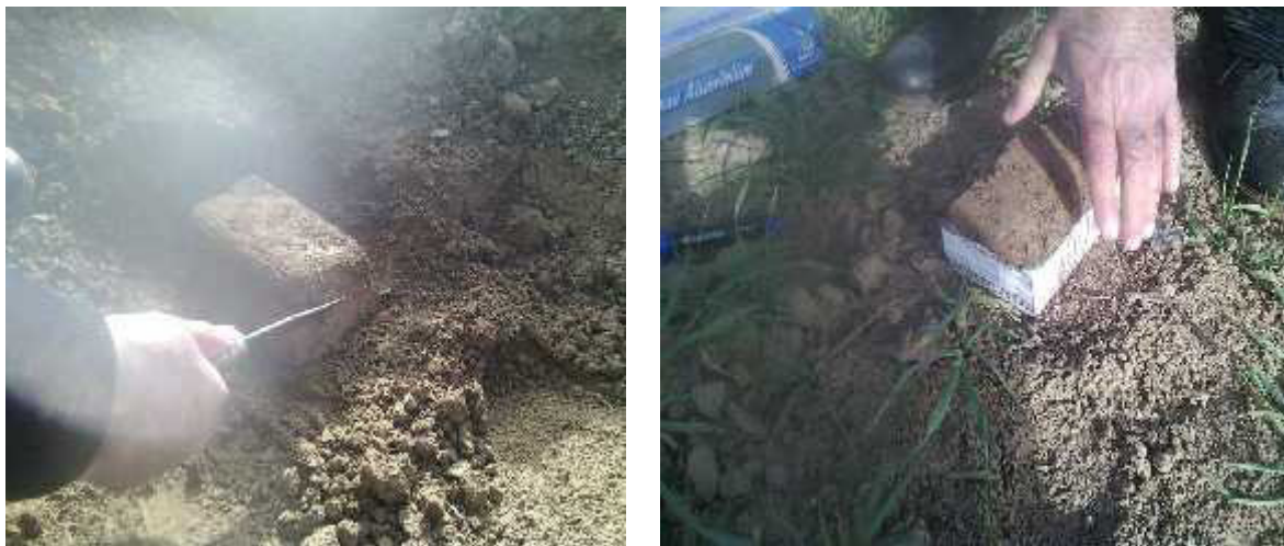
Photo VI.1 : Echantillonnage d'un bloc de sol à structure conservée
